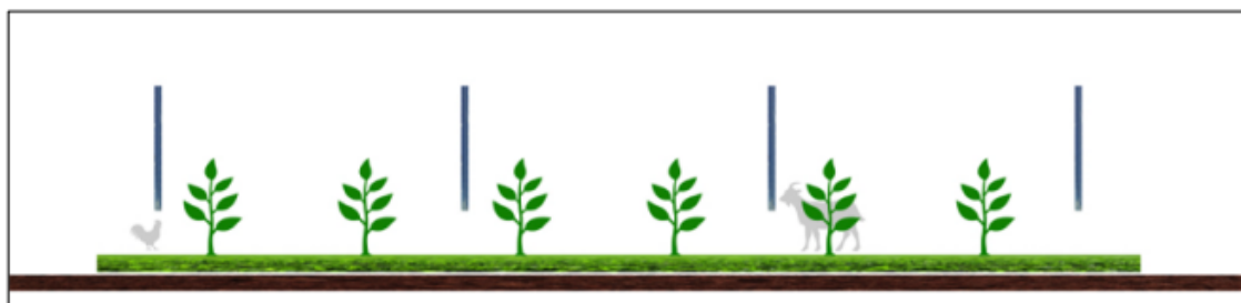
Figura 5.3 - Sistema agrivoltaico in cui i moduli fotovoltaici sono disposti verticalmente. La coltivazione avviene tra le file dei moduli fotovoltaici, l'altezza minima dei moduli da terra influenza il possibile passaggio di animali (TIPO 3).
